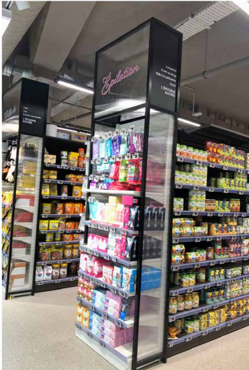
Structure tubulaire d'habillage de TG alu laqué. Panneaux polycarbonate alvéolaire et texte volume PVC imprimé découpé.
